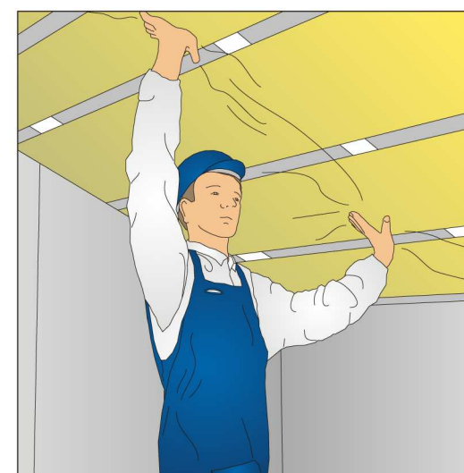
Przyklejanie folii paroizolacyjnej
